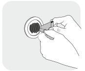
4. Applicare la colla sul retro del supporto, non riempire completamente la sede. Apply glue to the back of the support. Do not fully fill the recess.
