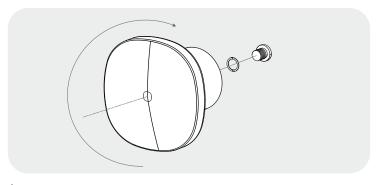
Posizionare l' O ring sulla filettatura della vite ed avvitare "CHIODO". L'O ring aiuta ad allineare "CHIODO" nella posizione preferita
