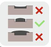
5. Un livello di colla troppo scarso o 3. Un livelio di colla troppo scarso o troppo abbondante non garantisce il corretto fissaggio di "CHIODO". An insufficient or excessive level of glue does not ensure proper fixation of "CHIODO".
