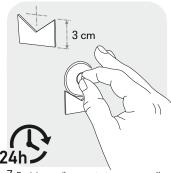
7. Posizionare il supporto temporaneo, Il centro di "CHIODO" sarà 3cm più in alto. Premere contro la parete il supporto ed applicare pressione per 2 minuti. Dopo 24 ore sarà possibile completare il montaggio.
